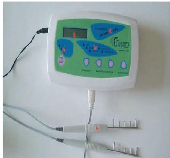
Рис. 1. Внешний вид аппарата «ЭМЛК 12-01». 1 – информационный жидкокристаллический индикатор; 2 – индикаторы параметров; 3 – индикаторы типа выходного сигнала; 4 – линейка индикаторов «Потенциал»; 5 – гребневидные электроды
