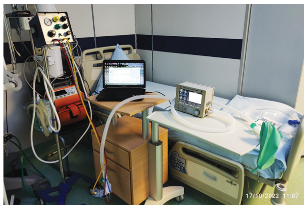
Рис. 3. Вариант подключения Измерителя в контур Перкуссионера: слева — Перкуссионер; посередине — ноутбук с программным обеспечением, подключенным к Измерителю; справа — Измеритель с тестовым легким Fig. 3. Option for connecting the Meter to the Percussionner circuit: left — Percussionner; middle — laptop with software connected to the Meter; right — Meter with test lung
