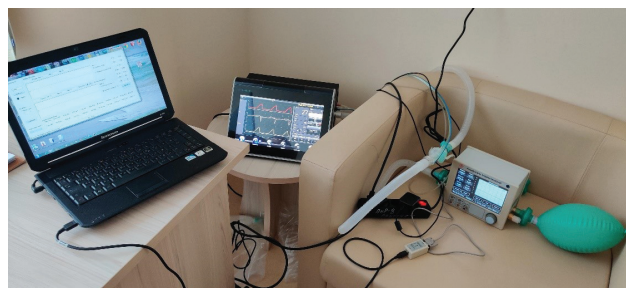
Рис. 2. Вариант подключения Измерителя в контур аппарата искусственной вентиляции легких: измеритель с тестовым легким (справа), аппарат ИВЛ «Беллавиستا 950» (посередине), ноутбук с разработанным программным обеспечением Измерителя (слева) Fig. 2. Option for connecting the Meter to the ventilator circuit Note: Meter with test lung (right), Bellavista 950 ventilator (middle), laptop with developed Meter software (left)
