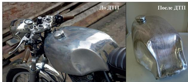
Рис. 12. Внешний вид бензобака мотоцикла “Yamaha SR 400 Cafe Racer”
